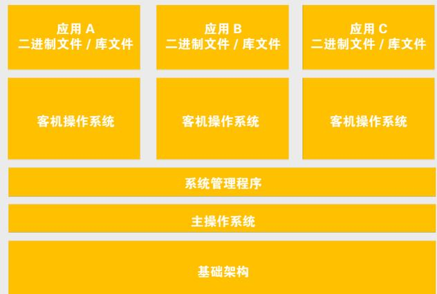
图 1：利用虚拟机（VMs）实现的传统虚拟化
